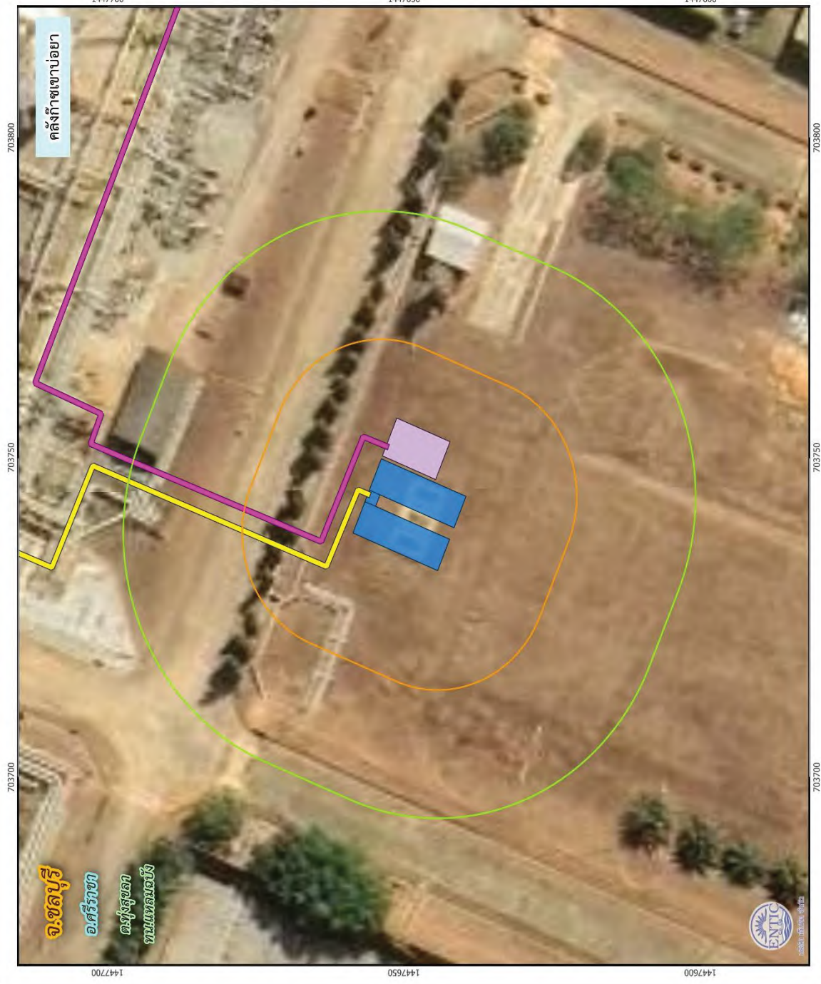
รูปที่ 4-22 ขอบเขตผลกระทบกรณีเกิดการรั่วไหลและติดไฟแบบ Jet Fire จากบริเวณถังเก็บก๊าซปิโตรเลียม ที่มีการติดตั้งใหม่ (ขนาดรั้ว 1 นิ้ว)
