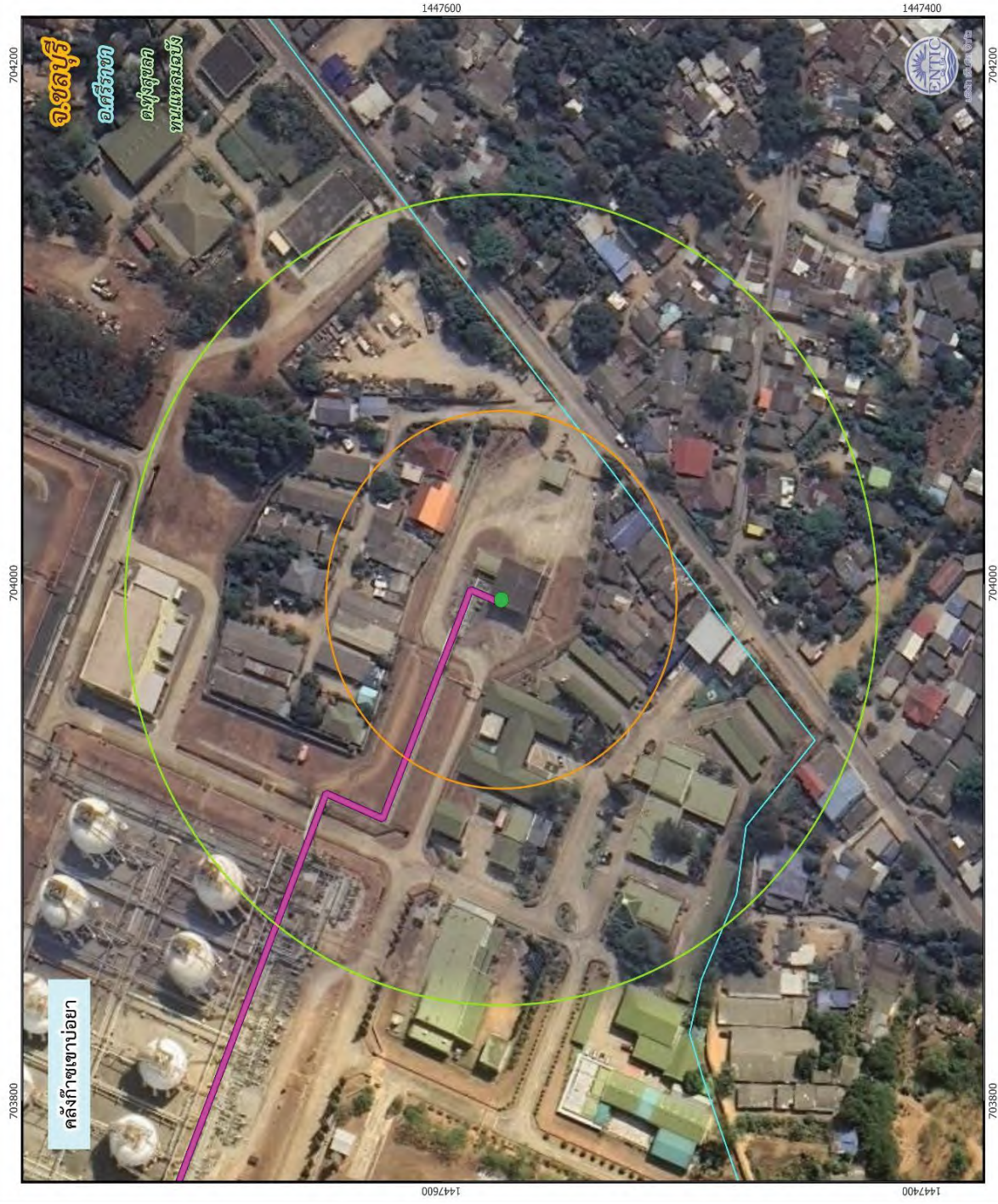
รูปที่ 4-29 ขอบเขตผลกระทบกรณีเกิดการรั่วไหลและติดไฟแบบ Jet Fire จาก Loading Arm ที่ติดตั้งใหม่ ขนาด 6 นิ้ว (กรณีแตกหัก)
