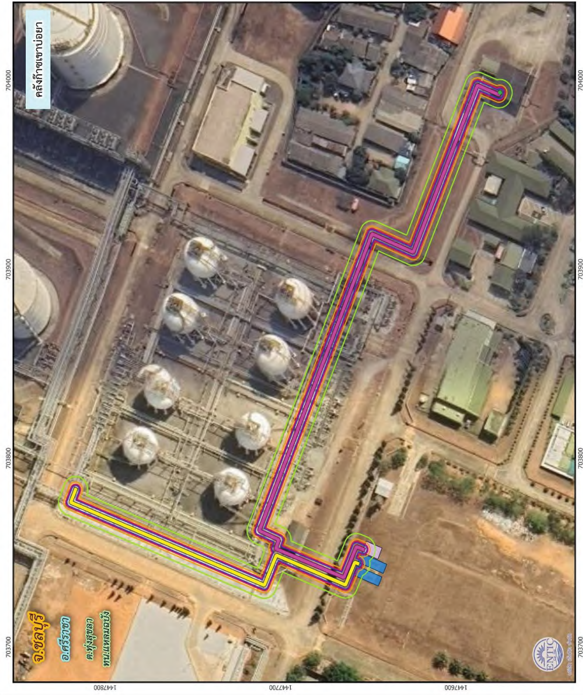
รูปที่ 4-36 ขอบเขตผลกระทบกรณีเกิดการรั่วไหลและติดไฟแบบ Jet Fire จากบริเวณท่อขนถ่าย Butane ที่มีการติดตั้งใหม่ ขนาด ๑๘ นิ้ว (ขนาดรั้ว 0.25 นิ้ว)
