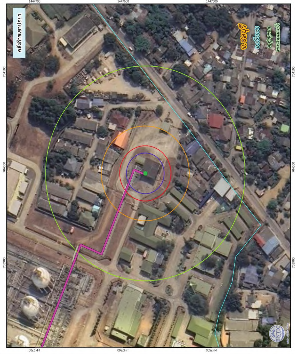
รูปที่ 4-33 ขอบเขตผลกระทบจากการรั่วไหลและติดไฟแบบ VCE จากบริเวณ Loading Arm ที่ติดตั้งใหม่ ขนาด 6 นิ้ว (ขนาดรั้ว 0.25 นิ้ว)
