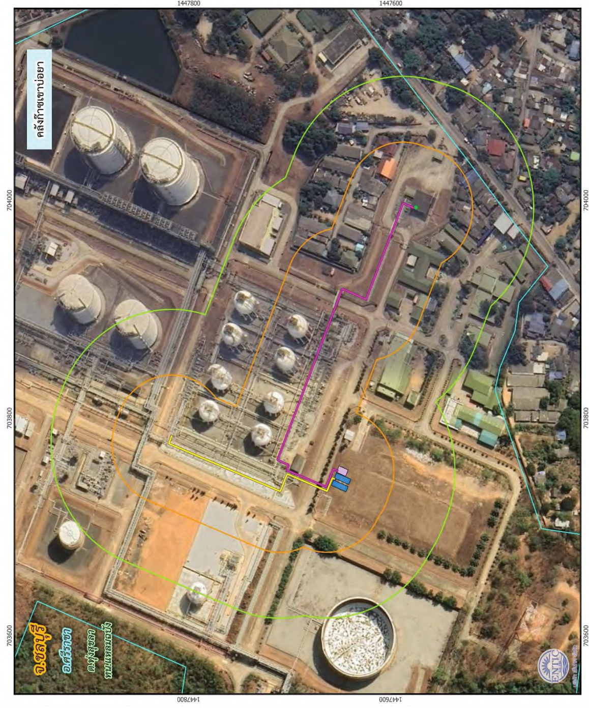
รูปที่ 4-38 ขอบเขตผลกระทบกรณีเกิดการรั่วไหลและติดไฟแบบ Jet Fire จากบริเวณท่อขนถ่าย Butane ที่มีการติดตั้งใหม่ ขนาด 8 นิ้ว (กรณีแตกหัก)
