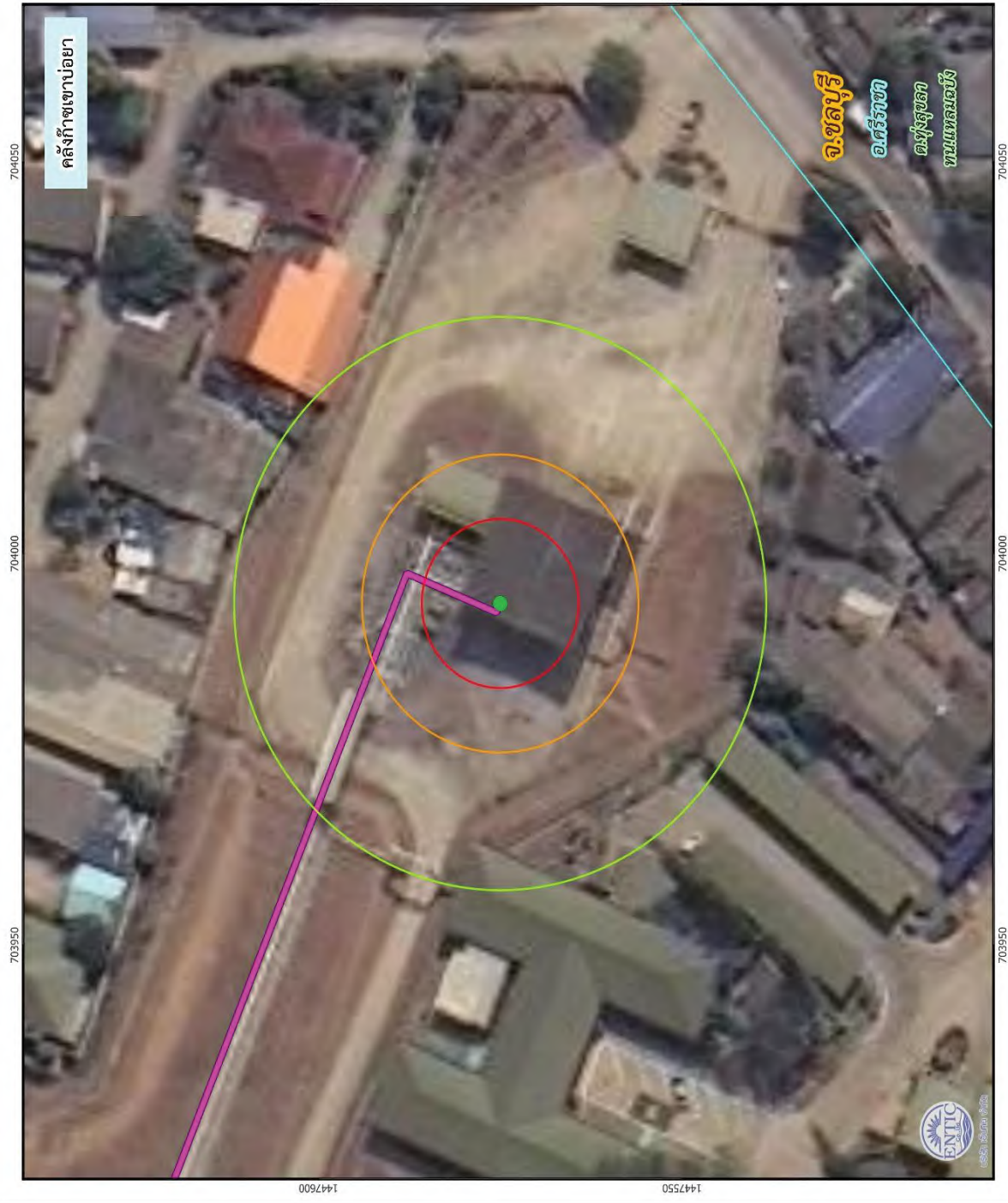
รูปที่ 4-28 ขอบเขตผลกระทบการเกิดการรั่วไหลและติดไฟแบบ Jet Fire จาก Loading Arm ที่ติดตั้งใหม่ขนาด 6 นิ้ว (ขนาดรัว 1 นิ้ว)
