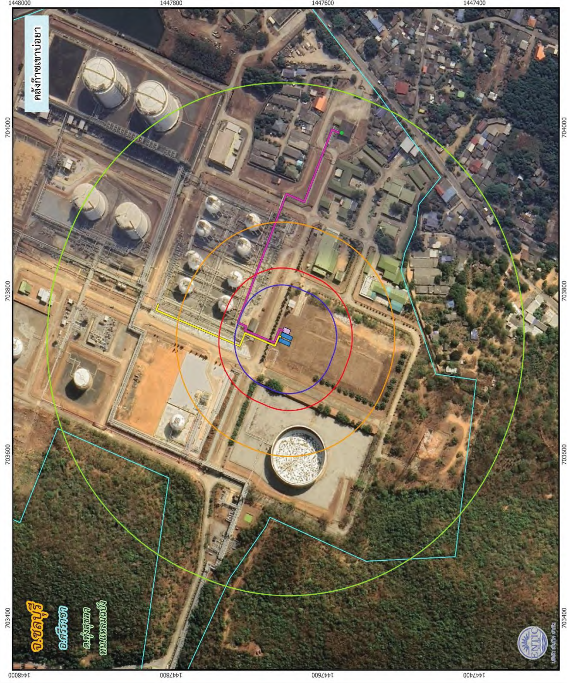
รูปที่ 4-26 ขอบเขตผลกระทบกรณีเกิดการรั่วไหลและระเบิดแบบ VCE จากบริเวณถังเก็บก๊าซเขปอ้อย ที่มีการติดตั้งใหม่ (ขนาดรั้ว 1 นิ้ว)
