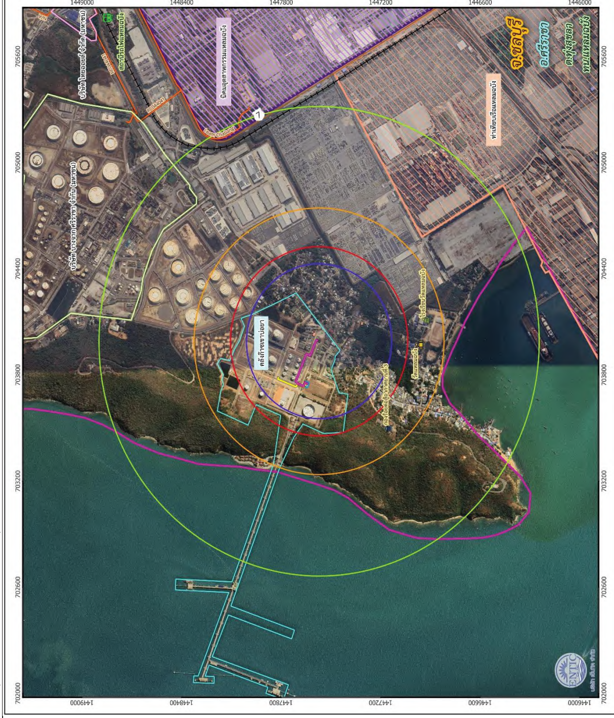
รูปที่ 4-32 ขอบเขตผลกระทบการรั่วไหลและติดเชื้อไฟแบบ Fireball จากบริเวณ Loading Arm ที่ติดตั้งใหม่ ขนาด 6 นิ้ว (กรณีแตกหัก)
